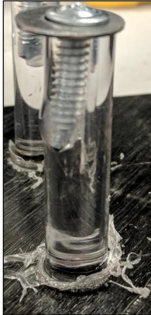
Figure 97: Neat-Resin Shear Stud
