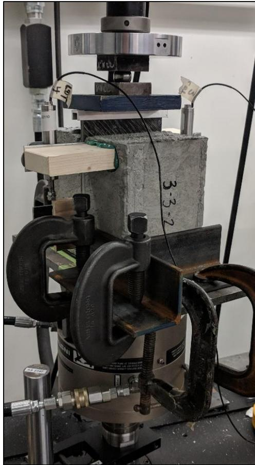
Figure 98: Concrete-TP Stud Testing Setup
