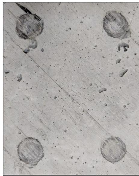
Figure 103: Failed PETg Concrete-TP Stud
